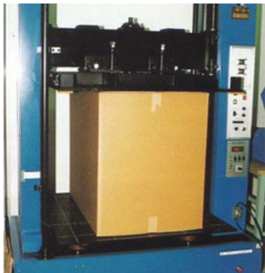
شکل ۷- آزمون مقاومت تراکم وارده بر روی لایه مقوای کنگره‌ای
