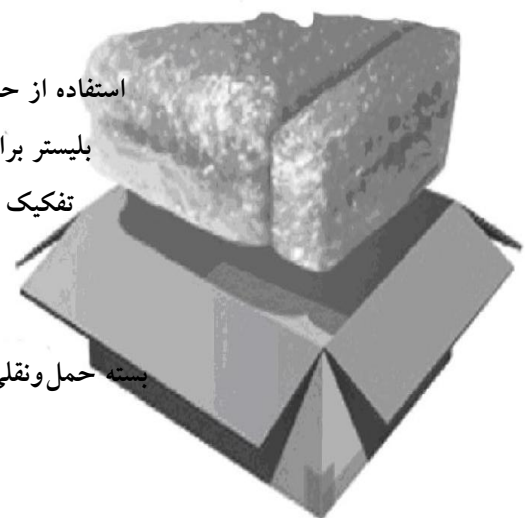
شکل ۵- مقاوم سازی بسته بندی اولیه با مواد پلیمری
