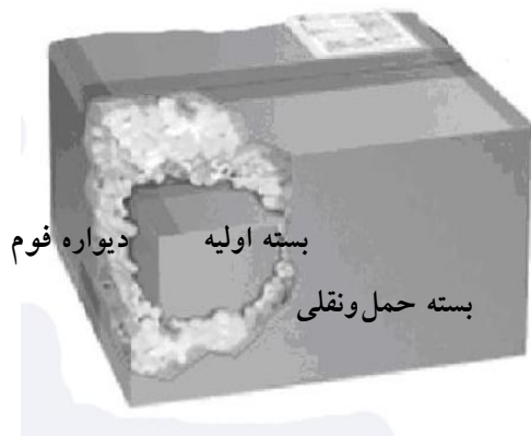
شکل ۳- بسته بندی اولیه در داخل بسته بندی ثانویه به وسیله مواد محافظ
