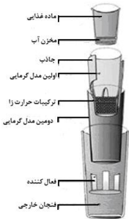
شکل ۴- مقطع درونی فنجان خود گرم شونده
