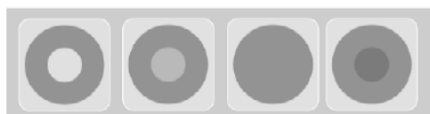
شکل ۶- افزایش شدت رنگ در مرکز دایره نشانگر تغییرات دمایی در شناساگر دما-زمان [۵].
