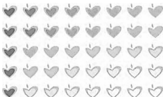
شکل ۵- تغییر شدت و اشاعه رنگ در امتداد خط راست نشانگر تغییرات دمایی در شناساگر دما-زمان [۵].
