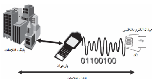
شکل ۳- چگونگی عملکرد برچسب‌های شناسایی امواج رادیویی [۵].
