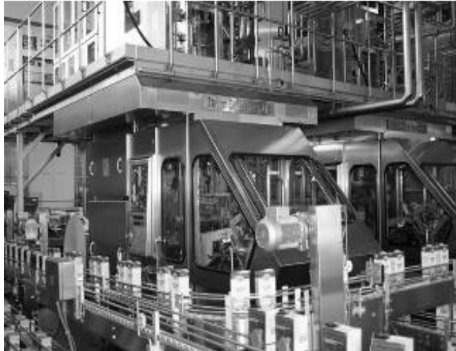
شکل ۵- سامانه بسته‌بندی اسپتیک برای بسته‌های نیمه سخت
