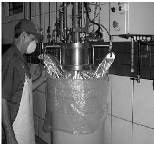
شکل ۲- فرایند پر کردن و دربندی به روش اسپتیک
