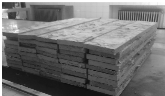
شکل ۳- پانل‌های ساخته شده از ضایعات بسته‌های چند لایه پانل‌های ساخته شده از دورریزهای بسته‌های چند لایه با استفاده از روکش‌های چوب گردو با جرم ویژه ۰/۶ گرم بر سانتی‌متر مکعب و ضخامت ۱ میلی‌متر روکش می‌شوند. فرایند روکش کردن در فشار ۳۰ بار و حرارت
