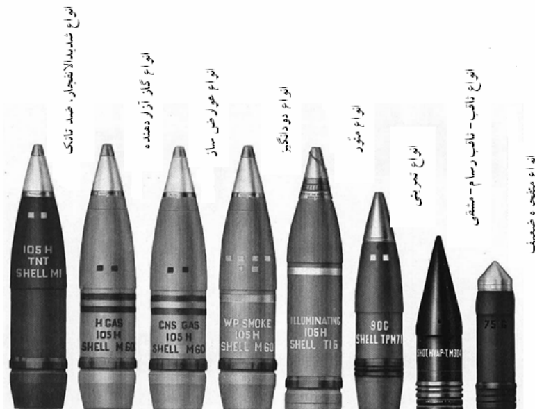
شکل ۵- شناسایی مهمات توپخانه مطابق نوع پوشش (رنگ بدنه، رنگ نوارها و نوشته‌ها) [۶]
