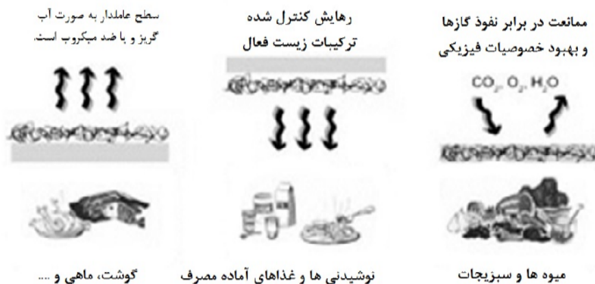
شکل ۳- طراحی نانوکامپوزیت‌های نانولیفی برای مواد بسته‌بندی جدید مواد غذایی [۸]
