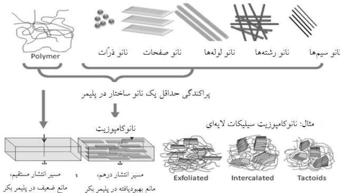
شکل ۱- ترسیم شماتیک تهیه نانو کامپوزیت‌ها و بهبود ویژگی‌های ممانعت‌کنندگی [۴]
