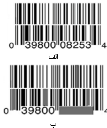
شکل ۷- شکل الف، نشان‌دهنده محصولی که آماده مصرف می‌باشد و شکل ب، نشان‌دهنده محصول منقضی شده می‌باشد که این بارکد امکان اسکن شدن را ندارد.
