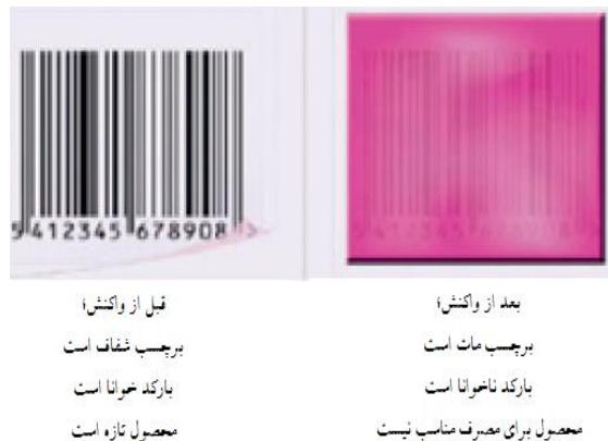
شکل (۴): نحوه تغییر رنگ نشان‌گر زمان - دما Cryolog's TRACEO®
