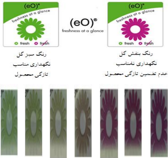
شکل (۳): تغییر رنگ نشان‌گر زمان - دما Cryolog's eO® [۶]
