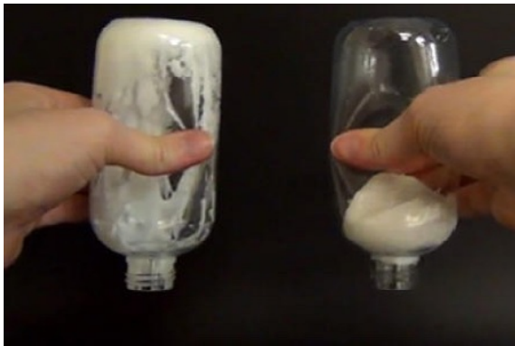
شکل (۶): بسته‌بندی معمولی (سمت چپ)، بسته‌بندی با سطح فوق آب‌گریز (سمت راست) [۲۱].
