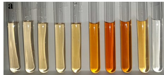
شکل (۵): پاسخ رنگی عصاره پوست میوه سیب در رنج pH ۳ تا ۱۲ (از چپ به راست) (شکل ۵a). مقادیر جذب نوری عصاره پوست میوه سیب تغییر رنگ یافته در طول موج ۳۰۰ تا ۸۰۰ نانومتر (شکل ۵b).
