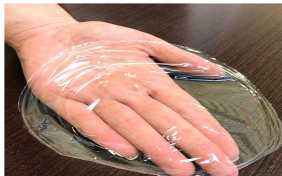
شکل (۲): نمونه‌ای از فیلم خالص کیتوزان تهیه شده از محلول آبی ۱ درصد وزنی کیتوزان در اسید استیک ۲ ۱ درصد (حجمی/حجمی) [۳]
